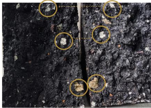
Figura 13. Falla especímenes elaborados con 10% RCD.
