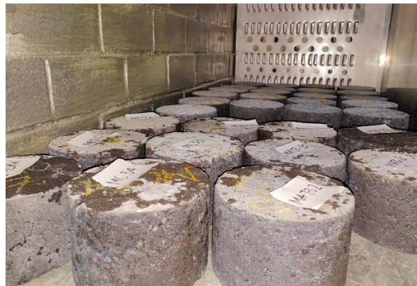
Figura 6. Secado de especímenes hasta lograr una saturación del 70% al 80 %.
