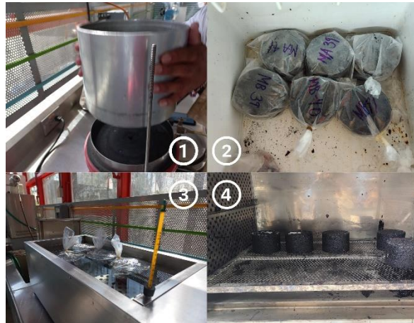
Figura 5. Acondicionamiento de especímenes (1) Saturación al vacío, (2) Ciclo de congelamiento, (3) Baño de agua, (4) Acondicionamiento en horno a 25°C.
