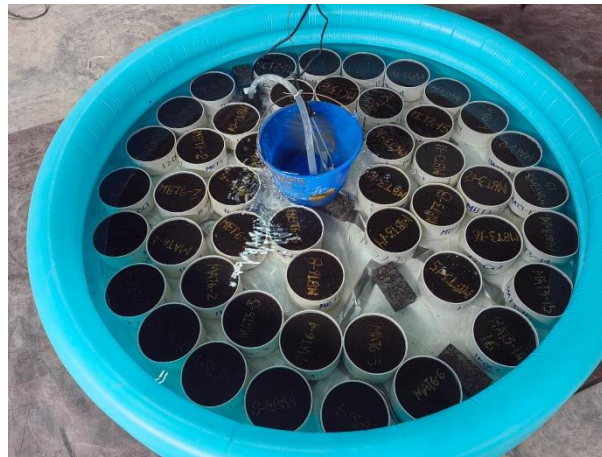
Figura 3. Proceso de envejecimiento de especímenes
